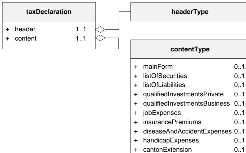
Abbildung 7: Grundstruktur der Meldung mit Header- und Content-Type.
