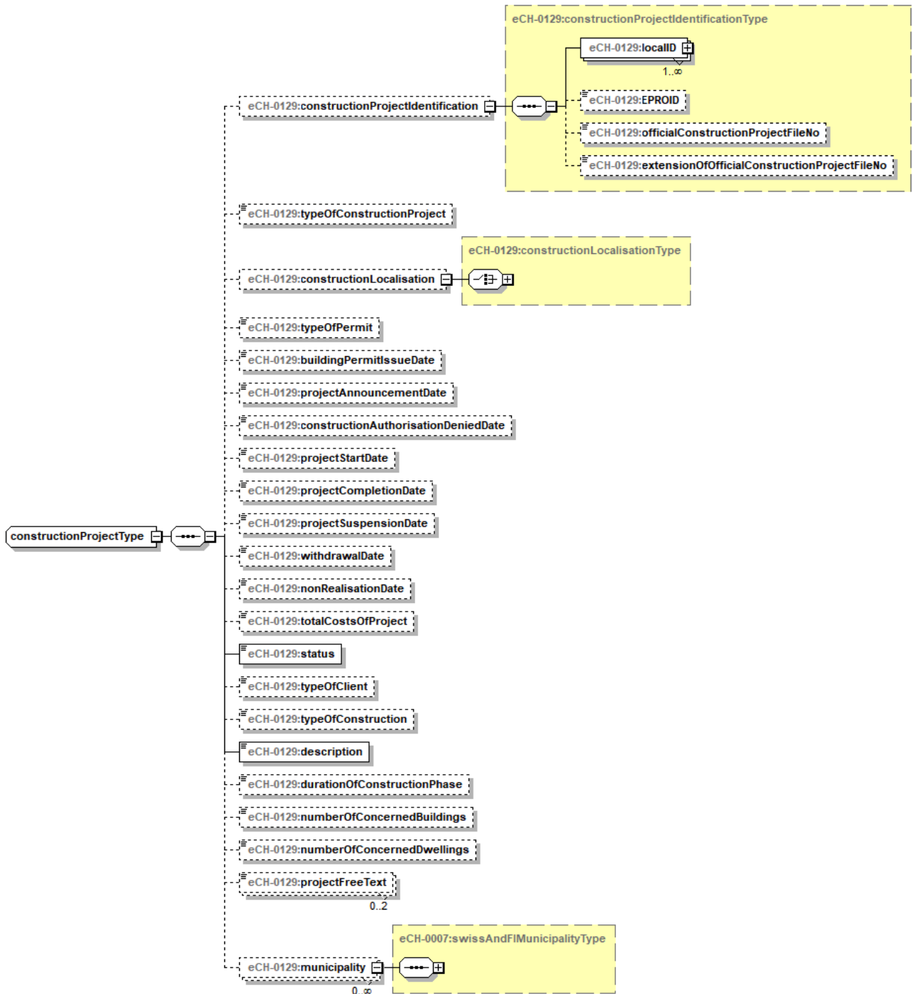
Abbildung 3: Entität Bauprojekt - constructionProjectType
